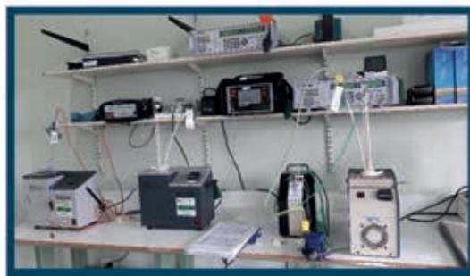
Calibración por simulación de indicadores de temperatura para termocuplas tipo J, K, S, B, R, T en el rango de -20°C hasta 1400°C.
