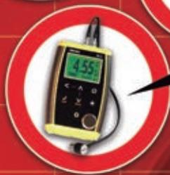
Medidor por ultrasonido y de dureza
